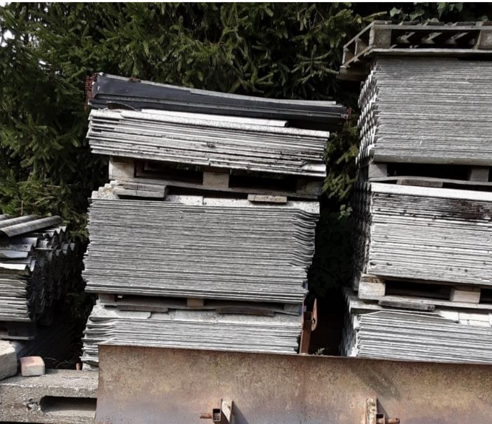
Fot. 2. Zmagazynowane płyty faliste
